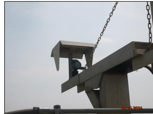
รูปที่ 2.13 เครื่องตรวจวัดคุณภาพน้ำอัตโนมัติ
