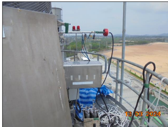
รูปที่ 3.2 การเก็บตัวอย่างคุณภาพอากาศในปล่องระบาย บริเวณ ปล่องหน่วยผลิตไอน้ำ HRSG 32
